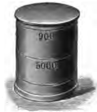
Fig. 13. — Double tamis pour l'essai des ciments.
